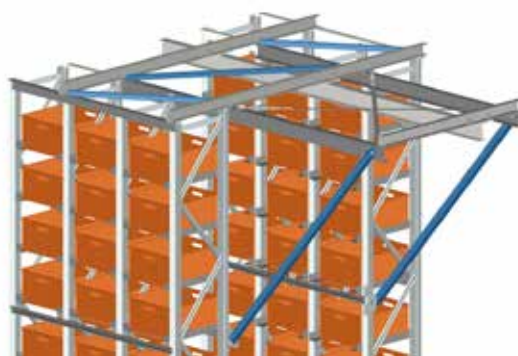
Konstrukce výběhu zakladače
