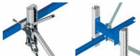
Systémy zavětrování zajišťují požadované tolerance (FEM 9.832).
